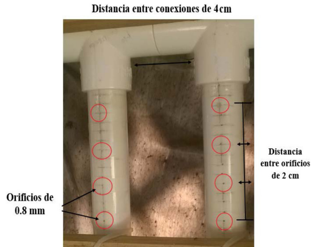
Figura 3. Dimensión de los orificios del sistema automático.
