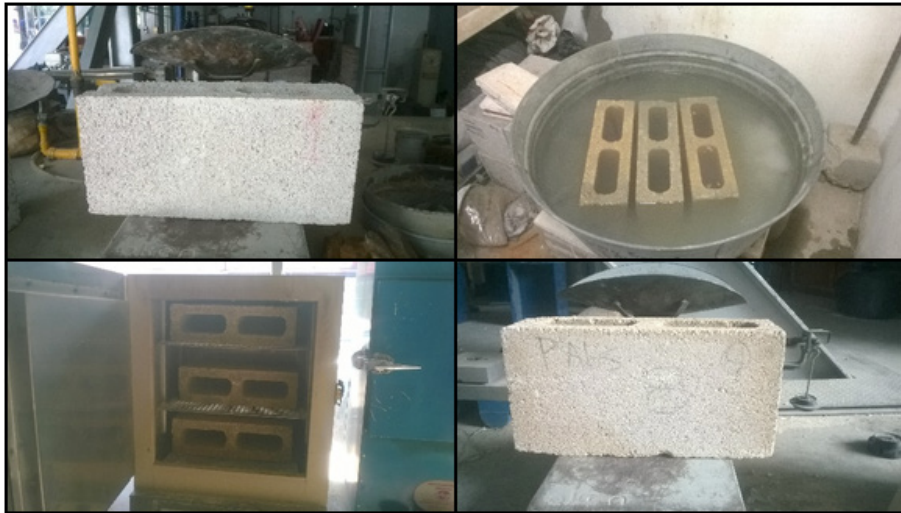
Figura 2. Fotografías que muestran las distintas etapas del ensayo de absorción de agua
