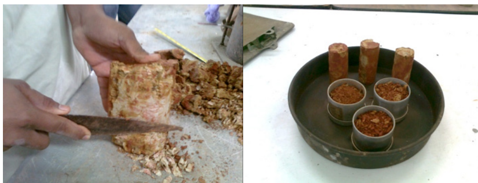
Figura 2. Labrado de especímenes para el ensayo triaxial
