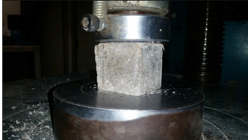
Figura 1. Ensayo de cubo de mortero en prensa universal
