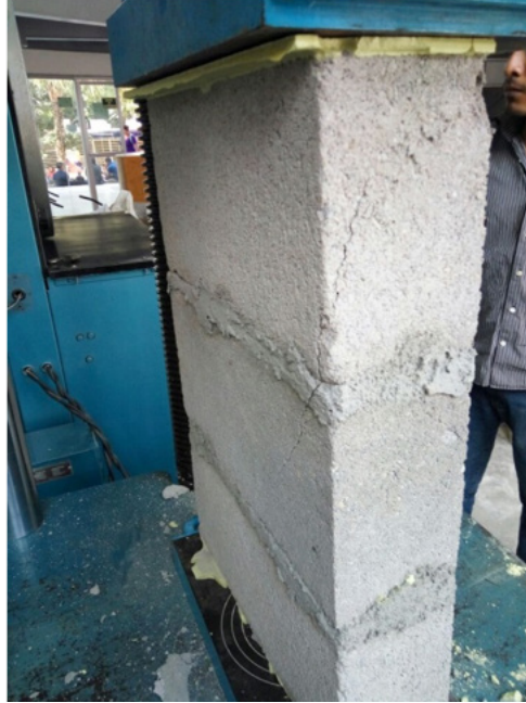
Figura 4. Ensayo de compresión en pila de bloques
