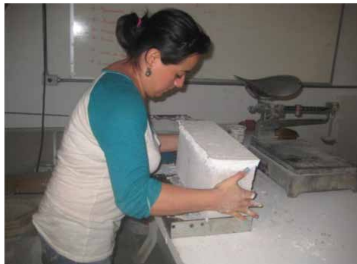
Imagen 19. Proceso de cabeceo de piezas. Fuente: Elaboración propia
