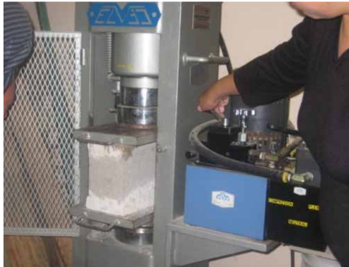
Imagen 14. Prueba de compresión. Fuente: Elaboración propia
