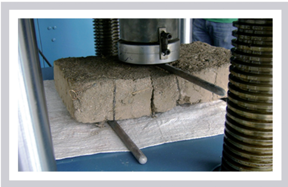
Figura 4. Prueba de flexión de las piezas de adobe de barro (Ovando de la Cruz y Ruíz Castellanos, 2010)
