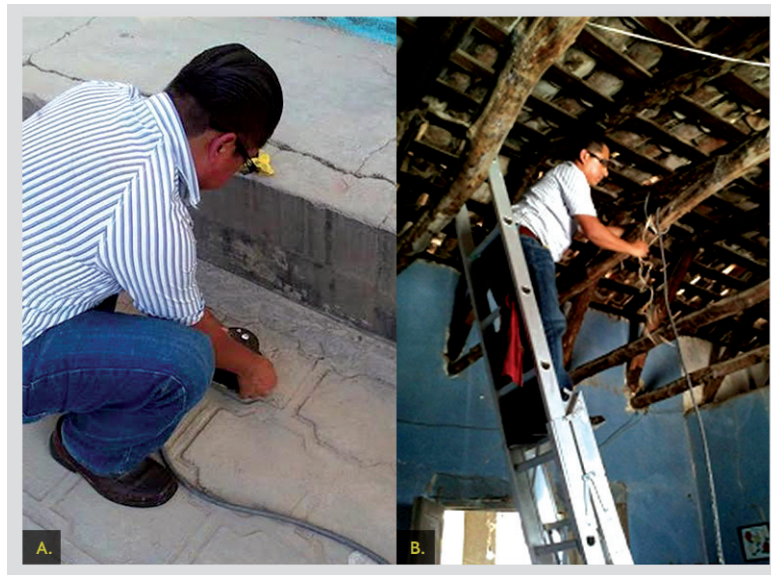
Figura 2 y 3. a) Instalación del acelerómetro en el suelo, b) Instalación del acelerómetro al interior de la vivienda
